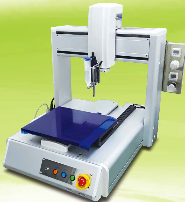
■ 搭载表面涂层胶阀的桌上型涂布装置
