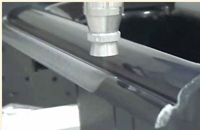
在汽车零部件上涂上金属涂料 即使是弯曲面，也可以无掩膜涂装
