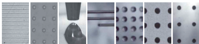
硅酮 粘合剂 50μm宽 UV 硬化树脂 38μmφ 硅酮树脂 (500Pa·s) 纳米银膏 50μm宽 纳米银膏 70μmφ 9号锡膏 50μmφ 导电 粘合剂 50μmφ
