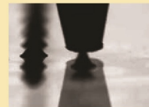
サイドビューイメージ ハンダペースト Type6 Φ180μm
