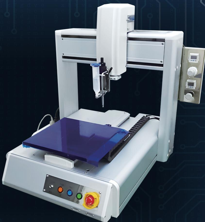
搭载表面涂层胶阀**桌上型喷涂装置**
